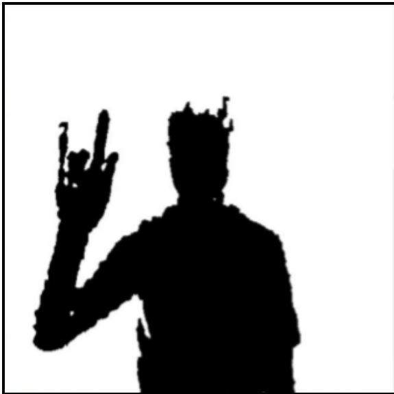
รูปที่ 3 การแปลงภาพจากกล้อง Kinect เป็นภาพขาวดำ
