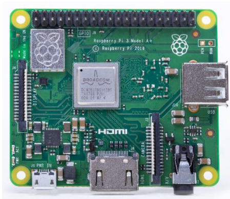
รูปที่2 บอร์ดคอนโทรลเลอร์สำเร็จรูป Raspberry Pi 3 Model A+
