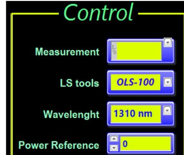
รูปที่ 5 การตั้งค่าการสอบเทียบอุปกรณ์แหล่งกำเนิดแสง
