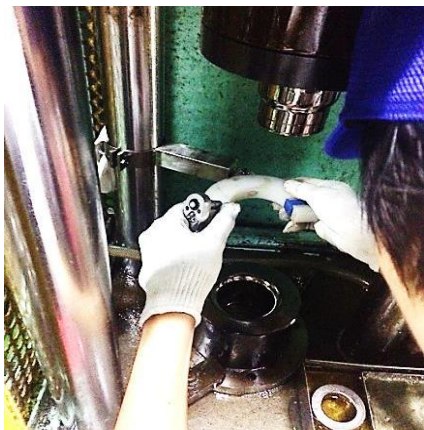
รูปที่ 9 กำหนดตำแหน่งอุปกรณ์กำหนดตำแหน่งชิ้นงาน
