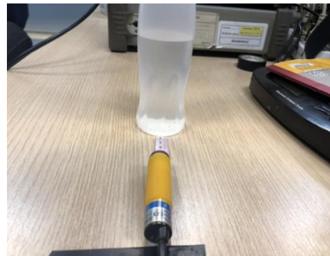
รูปที่ 2 การทดลองเพื่อหาระยะของพรีอิกซิมิต์เซนเซอร์ที่สามารถตรวจจับขวดน้ำที่บรรจุน้ำที่ระยะ 4 cm
