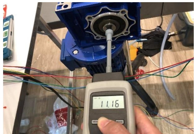
รูปที่ 12 การวัดความเร็วรอบที่ขับสายพานโดยใช้ทาโคมิเตอร์
