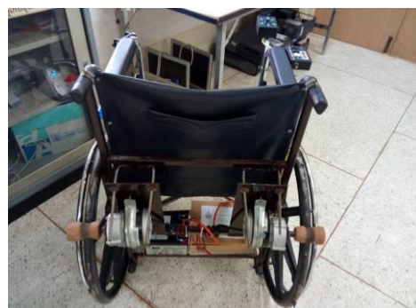
รูปที่ 18 ประกอบติดตั้งชุดขับเคลื่อน
