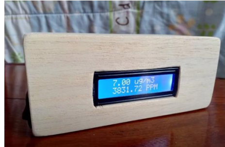
รูปที่ 8 ตัวอย่างชิ้นงานสำหรับโครงงานขนาดเล็กเครื่องวัดฝุ่น PM 2.5 ควบคุมด้วยอินเทอร์เน็ตทุกสรรพสิ่ง
