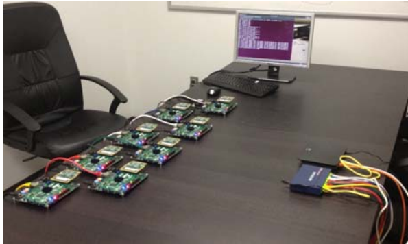
รูปที่ 8 Parallella Beowulf Cluster
