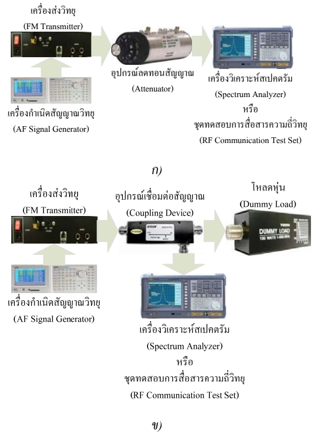
รูปที่ 11 การต่ออุปกรณ์วัดการเบี่ยงเบนความถี่
