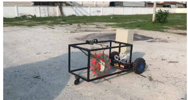
รูปที่ 13 การทดสอบการหยอดเมล็ดข้าวโพดของหุ่นยนต์หยอดเมล็ดพืชต้นแบบขนาดเล็ก
