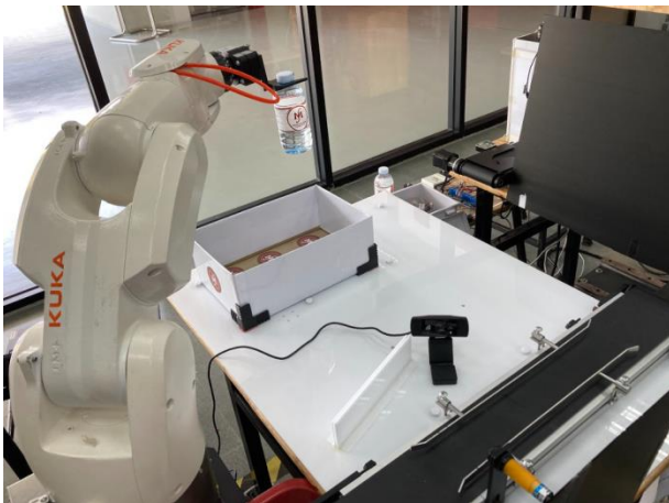
รูปที่ 20 ภาพการเคลื่อนที่ของหุ่นยนต์คูก้าเตรียมบรรจุภัณฑ์ลง กล่องในตำแหน่งที่ 6 ของขวดที่ 1
