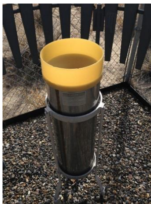
รูปที่ 3 เครื่องวัดปริมาณน้ำฝน มาตรฐาน National Oceanic and Atmospheric Administration [7]
