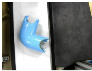
สังเกตข้อต่อพีวีซีคือ เสีย
