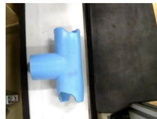
สังเกตข้อต่อพีวีซีคือ เสีย
