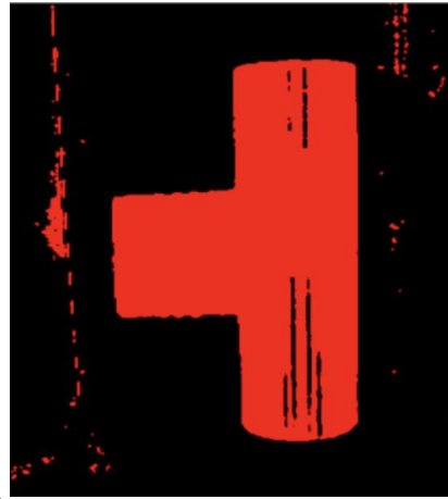
รูปที่ 6 ประมวลผลภาพด้วยฟังก์ชัน Basic Morphology
