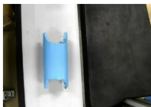
สังเกตข้อต่อพีวีซีคือ เสีย
