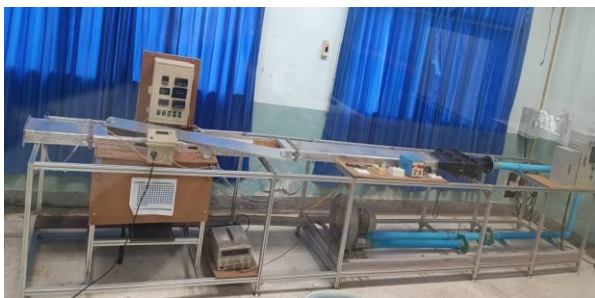
รูปที่ 3 ชุดทดลองท่อแลกเปลี่ยนความร้อนแบบช่องขนานสี่เหลี่ยมผืนผ้า
