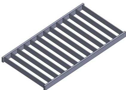
รูปที่ 6 รูปชิ้นงานทดสอบที่ค่าความสูงของแผ่นกั้นต่อความสูงของท่อสี่เหลี่ยม ( e/H ) คงที่ เท่ากับ 0.30 และ P/e = 2
