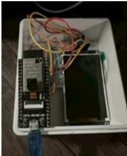
รูปที่ 6 การออกแบบเครื่องต้นแบบพัฒนาภาษามือโดยใช้เทคโนโลยี IOT ก่อนนำไปประกอบให้เรียบร้อย
