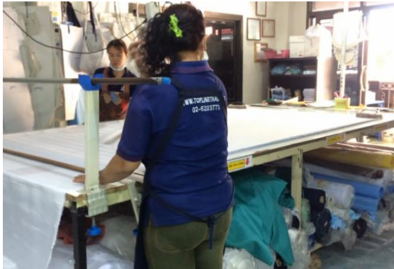
รูปที่ 4 ก่อนการแก้ไข : เก็บผ้าที่ใช้บ่อย ใกล้กับจุดเตรียมผ้า หลังการแก้ไข : ย้ายผ้าประเภทที่ใช้บ่อยมาไว้ใกล้กับจุดเตรียมผ้า
