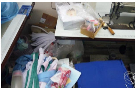
รูปที่ 3 ก่อนการแก้ไข : จุดวางของมีระดับต่ำกว่าเครื่องจักรมาก
