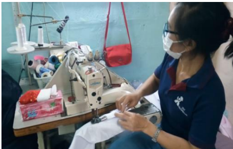
รูปที่ 7 ก่อนการแก้ไข : พนักงานต้องคอยมองหลอดด้ายเวลาด้ายใกล้จะหมด หลังการแก้ไข : เสนอแนะให้ใส่ยางถ่วงน้ำหนักหลอดด้าย
