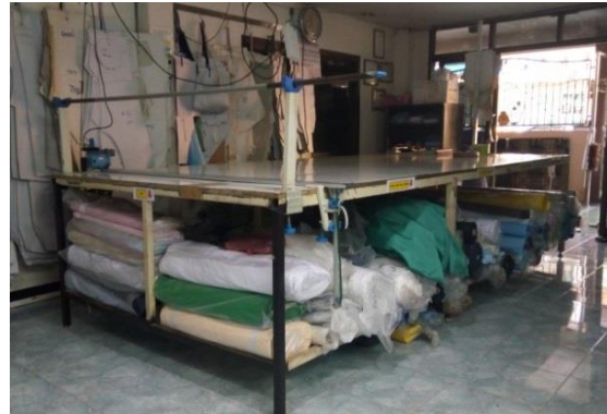
รูปที่ 4 ก่อนการแก้ไข : เก็บผ้าที่ใช้บ่อย ใกล้กับจุดเตรียมผ้า หลังการแก้ไข : ย้ายผ้าประเภทที่ใช้บ่อยมาไว้ใกล้กับจุดเตรียมผ้า
