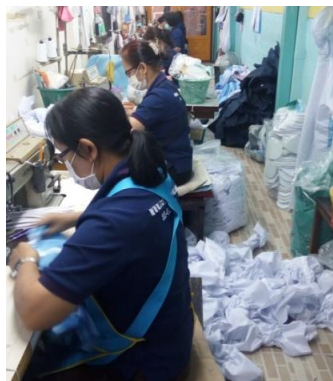
รูปที่ 8 ก่อนการแก้ไข : เกิดการผสมกันระหว่างชิ้นงานที่เสร็จแล้วกับยังไม่เสร็จ หลังการแก้ไข : ชิ้นงานที่เย็บเสร็จแล้วแยกใส่กระสอบ
