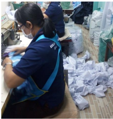
รูปที่ 5 ก่อนการแก้ไข : มีการขนย้ายระหว่างกระบวนการหลายรอบ หลังการแก้ไข : มีกระสอบใส่ผ้าที่เย็บเสร็จแล้ว เพื่อง่ายต่อการย้าย
