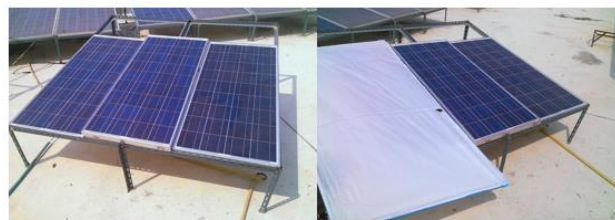
รูปที่ 4 การทดลองเปรียบเทียบประสิทธิภาพการติดตามกำลังไฟฟ้าของเซลล์แสงอาทิตย์
