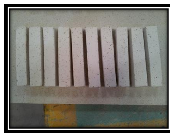
รูปที่ 5 ชิ้นงานหลังเผา ขนาด 1.5x1.5x6.5 นิ้ว
