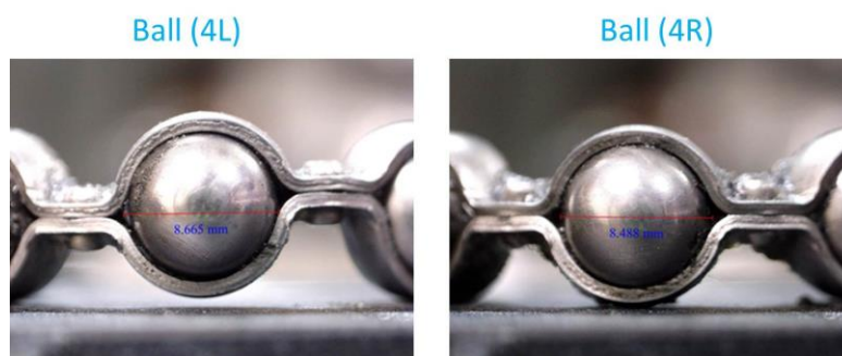
รูปที่ 28 ภาพถ่ายด้วยกล้องไมโครสโคปแสดงผิวของลูกปืน (Ball) ของแบริ่ง Rubbing Compound
