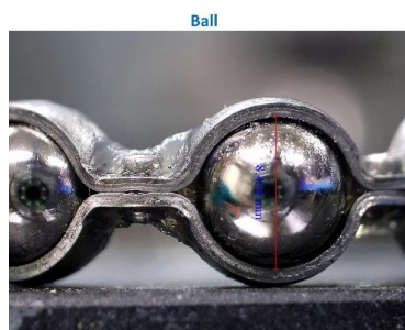
รูปที่ 15 ภาพถ่ายด้วยกล้องไมโครสโคปแสดงผิวของลูกปืน (Ball) ของแบริ่งใหม่
