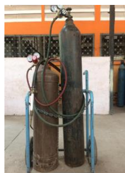
ภาพที่ 2 ชุดเครื่องมือและอุปกรณ์งานแล่นประสาน
