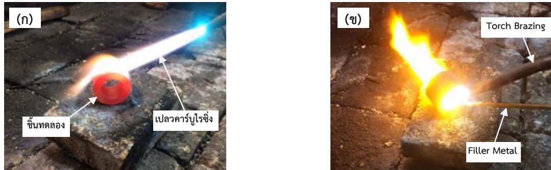
ภาพที่ 3 กระบวนการเชื่อมประสาน (ก) การให้ความร้อนก่อนการเชื่อมประสาน (ข) การเชื่อมประสานแนวเชื่อม
