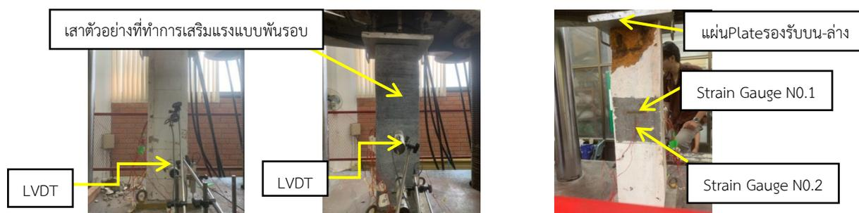
ภาพที่ 3.7 ภาพแสดงการทดสอบการรับแรงอัดทั้งแบบธรรมดาและแบบเสริมแรง
