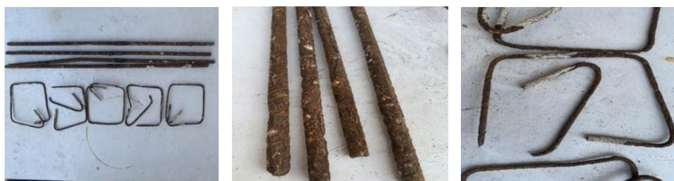
ภาพที่ 4.6 ลักษณะทางกายภาพของเหล็กเสริมเสาตัวอย่าง C4-SF0 -8D
