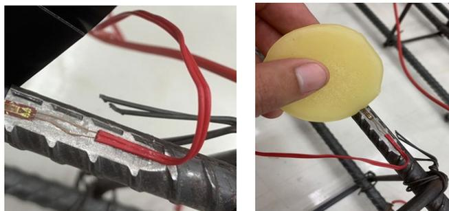
ภาพที่ 3.2 ภาพแสดงการติดตั้ง Electrical Strain Gauge
