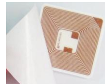
รูปที่ 9. แผงวงจร RFID ที่ใช้ในการวิจัย
