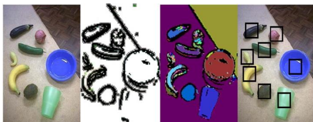
รูปที่ 2. แสดงการวิเคราะห์ภาพและการจับตำแหน่งของวัตถุ [2]
