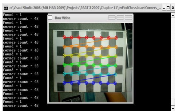
รูปที่ 16. แสดงการหาจุดตัดบนตารางหมากรุกเพื่อใช้ในการสอบเทียบกล้อง
