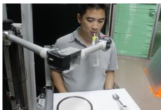
รูปที่ 31. แสดงการหยิบจับวัตถุของแขนหุ่นยนต์ร่วมกับระบบประมวลผลภาพ
