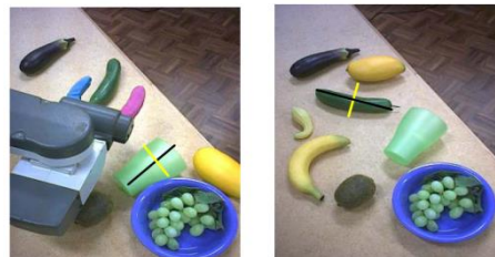
รูปที่ 3. แสดงรูปแบบการกำหนดจุดที่ต้องการหยิบ [2]
