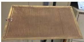
รูปที่ 11 แสดงเซนเซอร์วัดปริมาณน้ำฝนและวัดความชื้นในดิน
