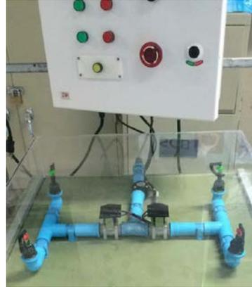
รูปที่ 12 แสดงชิ้นงานส่วนควบคุมปั๊มน้ำ และเซนเซอร์วัดปริมาณน้ำที่ใช้ไป
