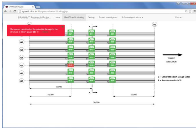
รูปที่ 8. หน้าจอการเฝ้าระวัง โดยแสดงข้อมูลที่ตรวจวัดได้จากเซ็นเซอร์ซึ่งอยู่ในระดับอันตราย (Strain Gauge S17 มีสีแดง พร้อมทั้งแจ้งเตือนความเสี่ยงที่อาจเกิดขึ้น)
