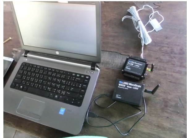
รูปที่ 5. เกจวัดความเครียด พร้อมกับ V-Link และสถานีฐาน
