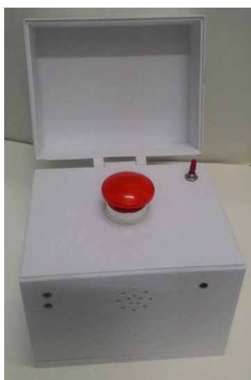
รูปที่ 5. แสดงลักษณะภายนอกของอุปกรณ์ส่งและรับการแจ้งเหตุฉุกเฉินผ่านเครือข่ายไร้สายและเอสเอ็มเอส
