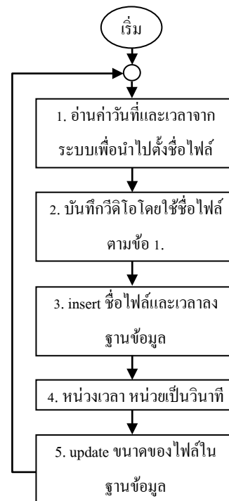
รูปที่ 11. ฟังก์ชันหลักการทำงานของโปรแกรมบันทึกวิดีโอ
