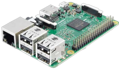
รูปที่ 1. บอร์ดราสเบอร์รี่พาย โมเดล B
