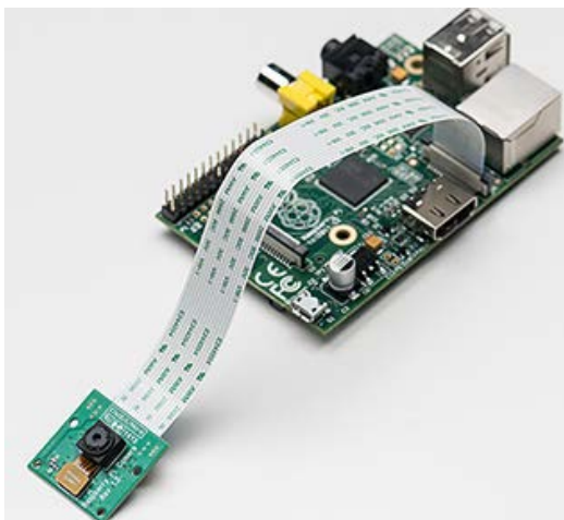
รูปที่ 2. ตัวอย่าง Pi camera
