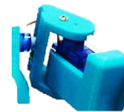
รูปที่ 10. การออกแบบจุดหมุนด้วยมอเตอร์เซอร์โว
