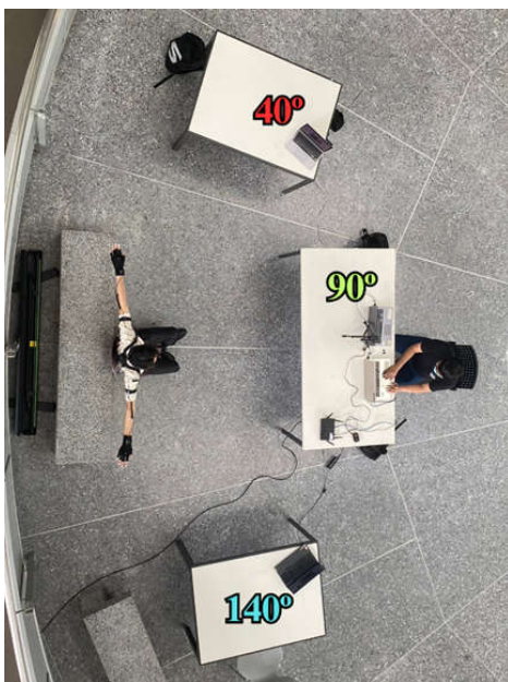
รูปที่ 5. องศาการติดตั้งกล้อง
