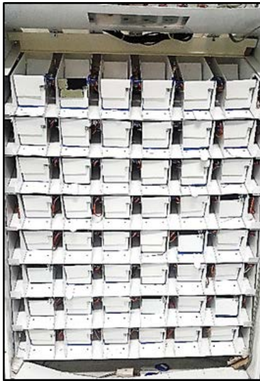
รูปที่ 8. อุปกรณ์เครื่องจัดเก็บกุญแจ
