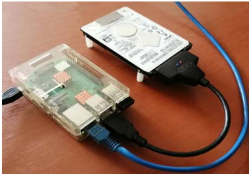
รูปที่ 7. การติดตั้ง External HDD กับราสเบอร์รี่พาย
