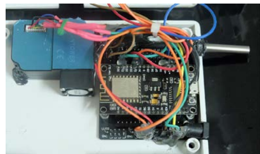
รูปที่ 7. ภาพรวมควบคุมระบบการทำงานตรวจวัดค่าฝุ่นละอองในอากาศ
