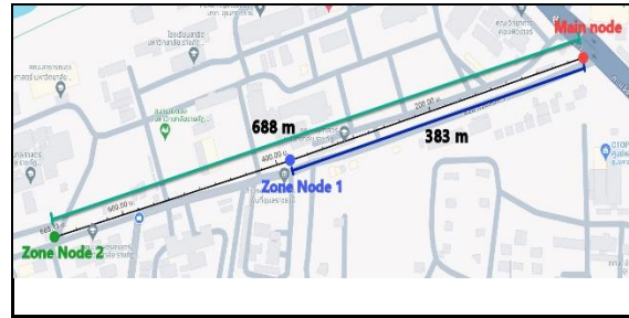
รูปที่ 8. แสดงตำแหน่งพิกัดของอุปกรณ์ส่งรับข้อมูลด้วยระยะทางสัมพันธ์
