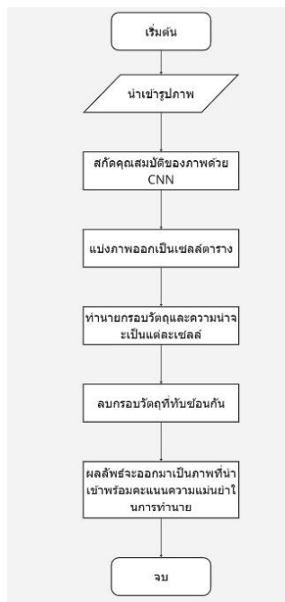
รูปที่ 1. แสดงกระบวนการทำงานของอัลกอริทึม YOLO
