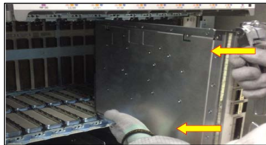
รูปภาพที่ 7 แสดงการดึงแผ่นวงจรพิมพ์ออกจากเครื่อง
