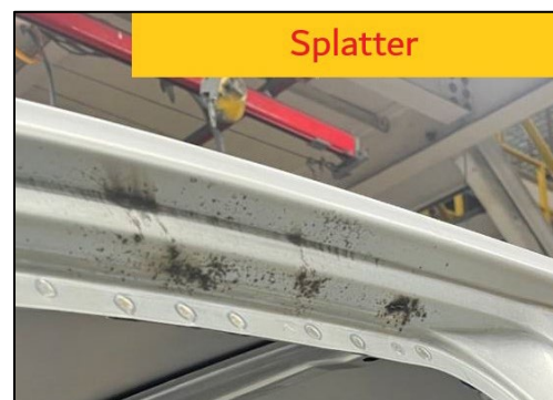
รูปภาพที่ 3 ของเสียลักษณะสะเก็ดไฟของชิ้นงาน
