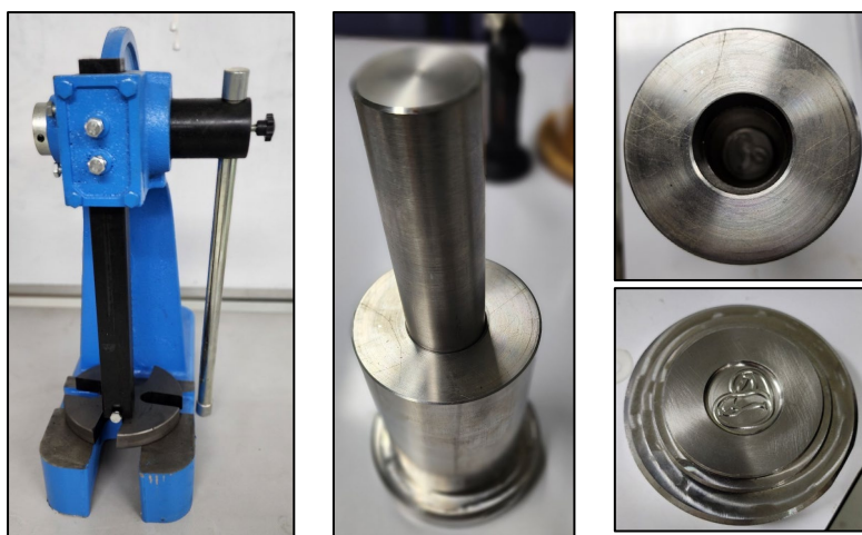
รูปที่ 1 เครื่องอัดอัดกาแฟบอลแบบพ่นเฟืองใช้มือโยก
