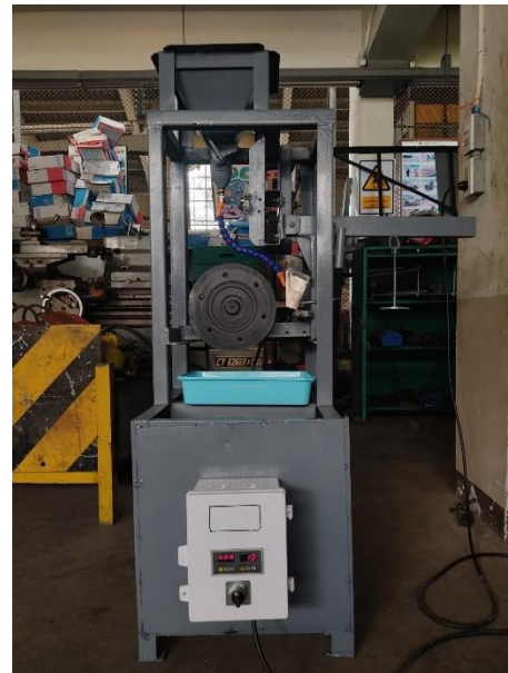
ภาพที่ 1 เครื่องทดสอบการสึกหรอตันแบบ (Prototype) ตามมาตรฐาน ASTM-G65
