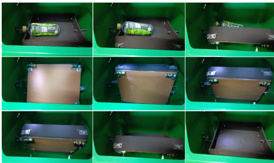
ภาพที่ 10 ลำดับการทำงานของถังคัดแยกขยะต้นแบบอัตโนมัติด้วยวิธี YOLOv8 อัลกอริทึม
