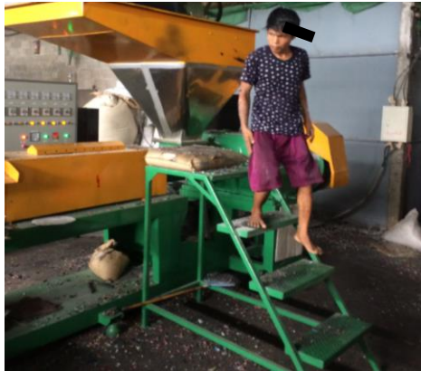
ภาพที่ 3 การยกถังขึ้นเติมวัตถุดิบใส่บน Hopper ของเครื่องหลอม
