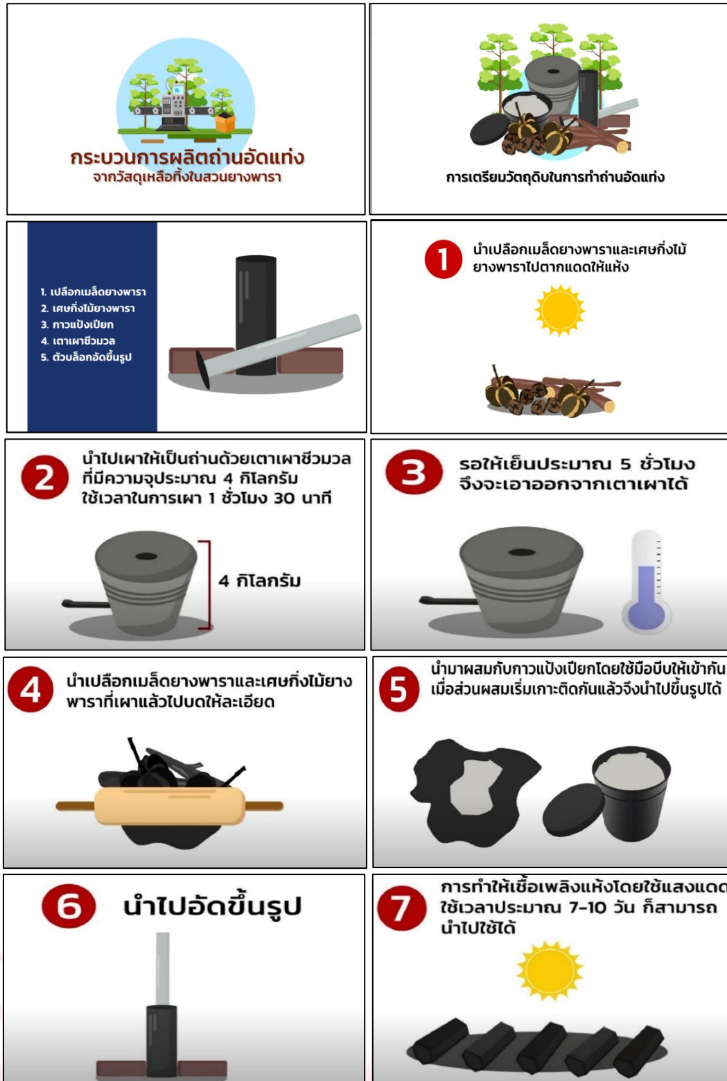
ภาพที่ 3 สื่ออินโฟกราฟิกที่ผลิตขึ้นแสดงขั้นตอนตั้งแต่การเตรียมอุปกรณ์ไปจนถึงกระบวนการผลิตถ่านอัดแท่ง
