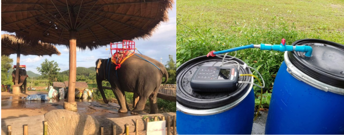
ภาพที่ 2 การเก็บข้อมูลการผลิตก๊าซชีวภาพจากมูลช้างโดยใช้เครื่องวัดก๊าซชีวภาพ
