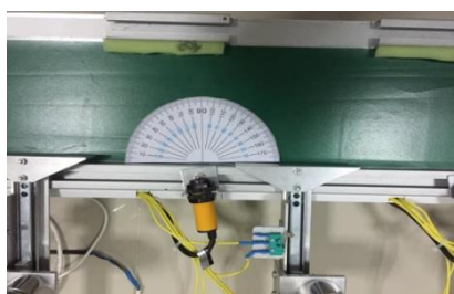
ภาพที่ 7 การปรับองศาของเซนเซอร์ของแขนผลัก
