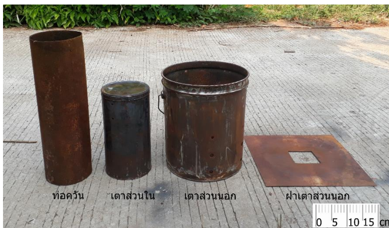
ภาพที่ 1 ส่วนประกอบเตาเผาถ่านที่เผาด้วยกระบวนการไพโรไลซิสแบบไหลขึ้น
