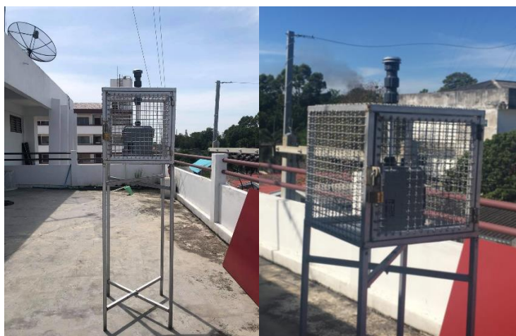
ภาพที่ 2 การเก็บตัวอย่างฝุ่น PM_{2.5} ด้วยเครื่องเก็บตัวอย่างฝุ่นละอองแบบปริมาตรต่ำ
