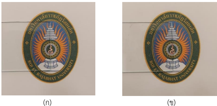
ภาพที่ 5 ภาพถ่ายฟิล์ม PVA ที่เคลือบบนกระจกสไลด์ (ก) ฟิล์ม PVA จากความเข้มข้น 1.0%W/V (ข) ฟิล์ม PVA จากความเข้มข้น 2.0%W/V
