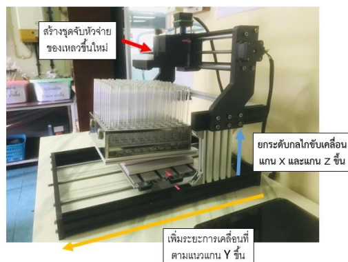
ภาพที่ 4 การปรับแต่งกลไกขับเคลื่อนของเครื่องดูดจ่ายของเหลวอัตโนมัติ
