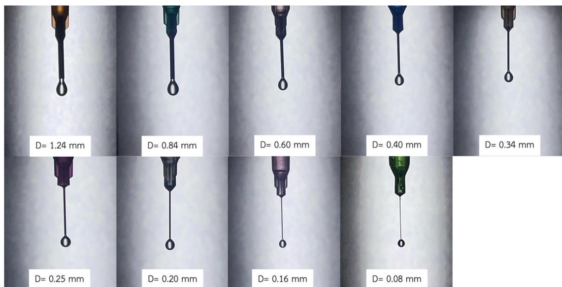
ภาพที่ 8 รูปร่างของหยดน้ำที่หยดด้วยเข็มฉีดยาที่มีเส้นผ่านศูนย์กลางขนาดต่าง ๆ
