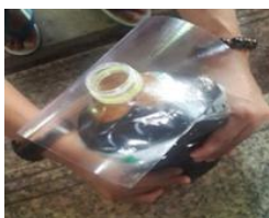
รูปที่ 1 แสดงการปิดฝาขวดด้วยแผ่นพีวีซีบาง เพื่อเก็บขวดให้อยู่ในสภาพไร้อากาศ
