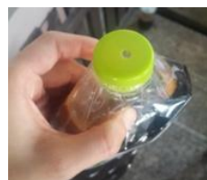
รูปที่ 2 แสดงฝาขวดถูกเจาะรูที่ตรงกลางซึ่งจะถูกใช้ในการดึงตัวอย่างก๊าซไปทำการวิเคราะห์
