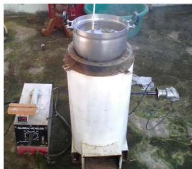
ภาพที่ 8 การทดสอบหาประสิทธิภาพโดยการต้มน้ำ
