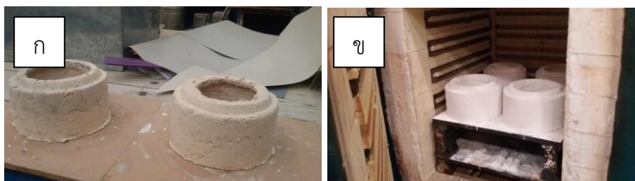
ภาพที่ 6 (ก) ห้องเผาไหม้ที่ขึ้นรูปเสร็จเรียบร้อยแล้ว
