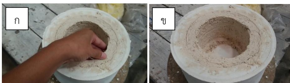
ภาพที่ 5 (ก) การขึ้นรูปห้องเผาไหม้
