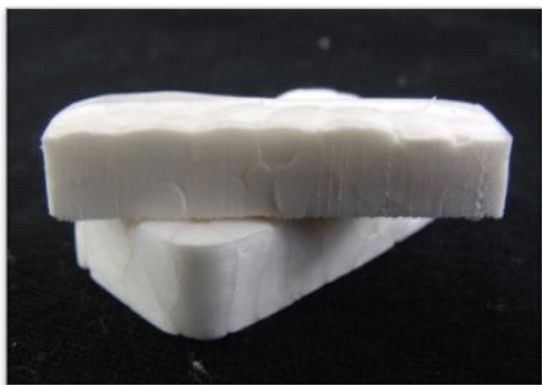
ภาพที่ 1 ภาพตัดขวางของไมโครเซลลูโลสโฟม จากพอลิแซ็กคาไรด์แอซิด
