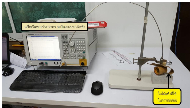
รูปที่ 1 ลักษณะการทดสอบใบไม้แห้งด้วยเครื่องวิเคราะห์หาค่าความเป็นฉนวนทางไฟฟ้า
